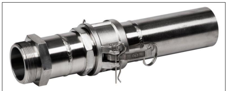
Gniazdo złącza CAMLOCK przyspawany doczołowo do rury bezszwowej EN 10216-2 (indeks rury: MPR-RBSZ-060X2,9-SS321) ze stali AISI 321.
