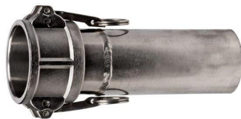
Gniazdo złącza CAMLOCK przyspawany doczołowo do rury bezszwowej EN 10216-2 (indeks rury: MPR-RBSZ-060X2,9-SS321) ze stali AISI 321.
