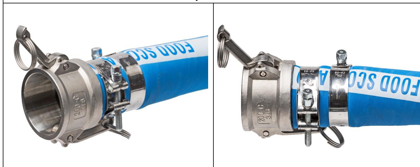
Złącze CAMLOCK typ C 2" ze stali nierdzewnej AISI 316 zamontowane do węża SCOTLAND NR DN51 za pomocą dwóch obejm SUPRA HEAVY DUTY W2
